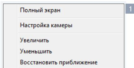
**Полный экран** — переход в полноэкранный режим; для выхода из полноэкранного режима нажмите «ESC»
