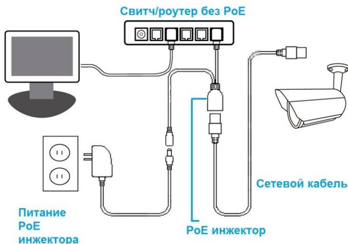
Рис.13.2.2. Схема подключения видеочамеры к сетевому оборудованию без поддержки PoE
