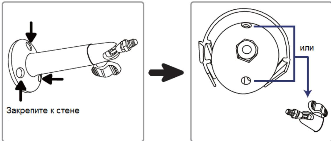
Рис.3.1.1. Монтаж видеокамеры LTV-ICDM1-B623L-F
