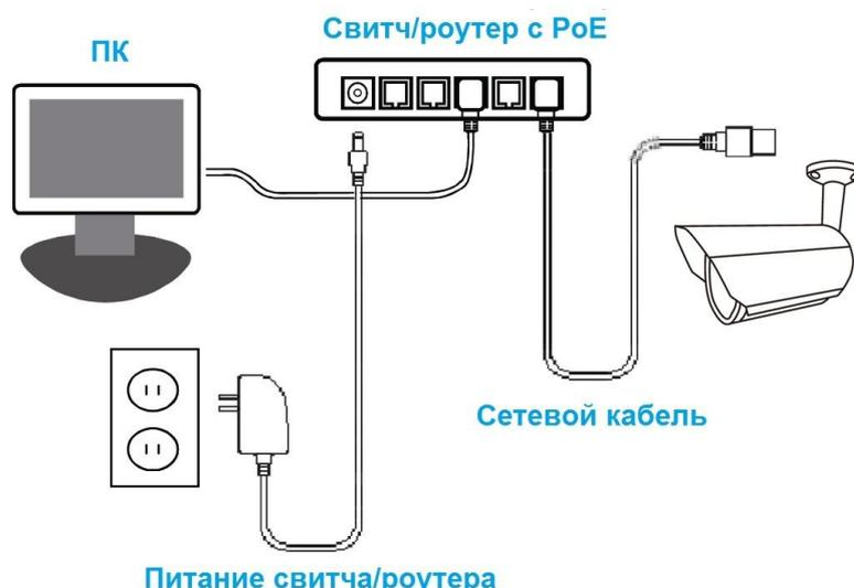
Рис.13.2.1. Схема подключения видеочамеры к сетевому оборудованию с поддержкой PoE
