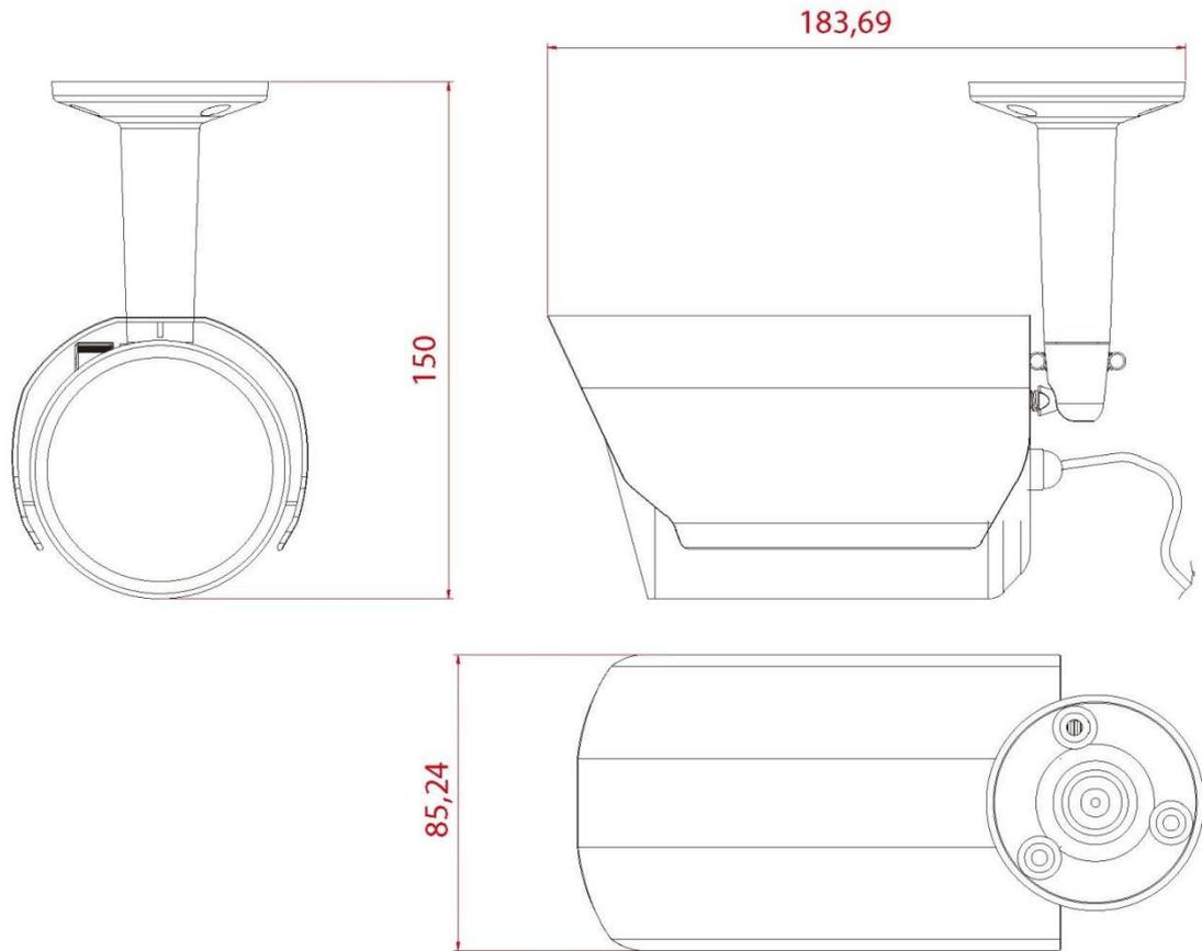
Рис.1.2.1. Габаритные размеры LTV-ICDM1-B623L-F
