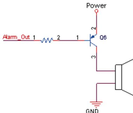
Рис.2.2.1. Схема подключения тревожного выхода видеокамеры LTV-ICDM1-B623L-F
