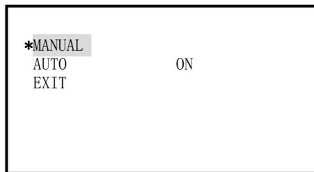
**MANUAL:** При активации этой функции система перепроверяет горизонтальную и вертикальную нулевую точку.
